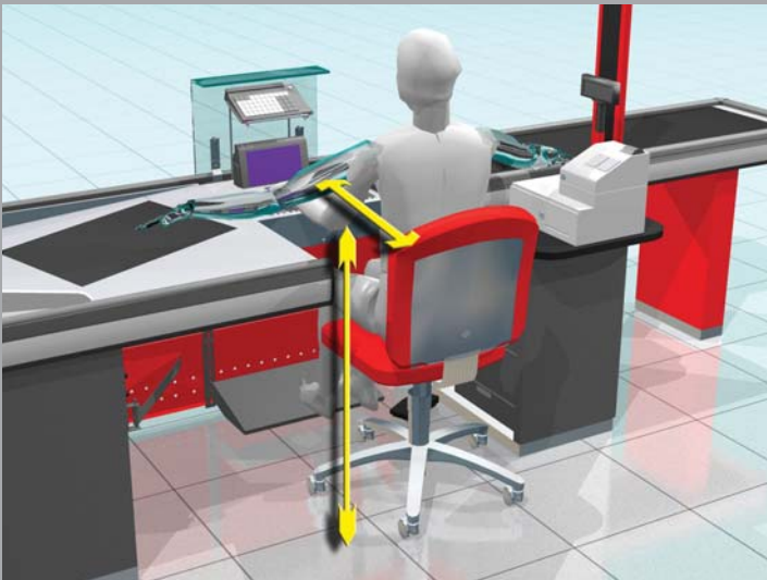
DISTANCIAS Y LIMITES DEL POSICIONAMIENTO DEL TRABAJADOR
